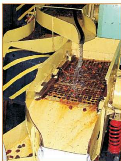
Грохот (сито) для сортировки янтаря по фракциям на обогатительной фабрике. 2007 г. Фото Ю.С. Кожемякина
