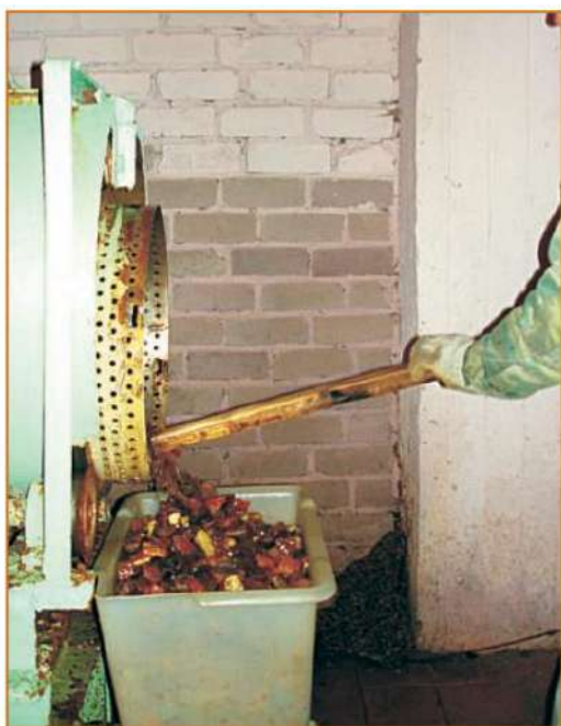
Выгрузка янтаря крупных фракций из промывочного барабана на обогатительной фабрике. 2006 г. Фото А.В. Баранова
